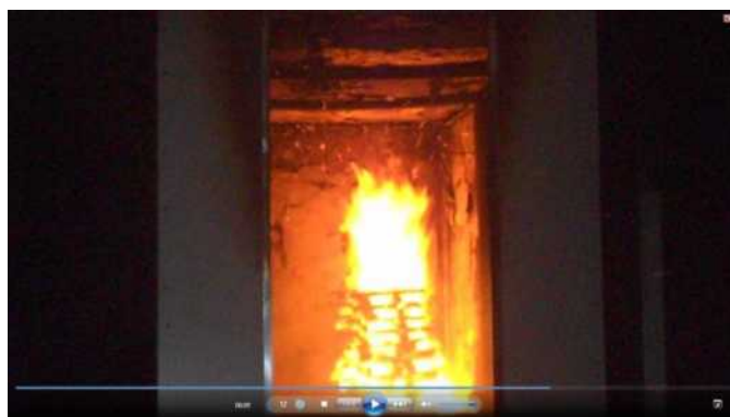
Fig. 11 – Desprinderea totală și distrugerea prin ardere a materialului izolant
