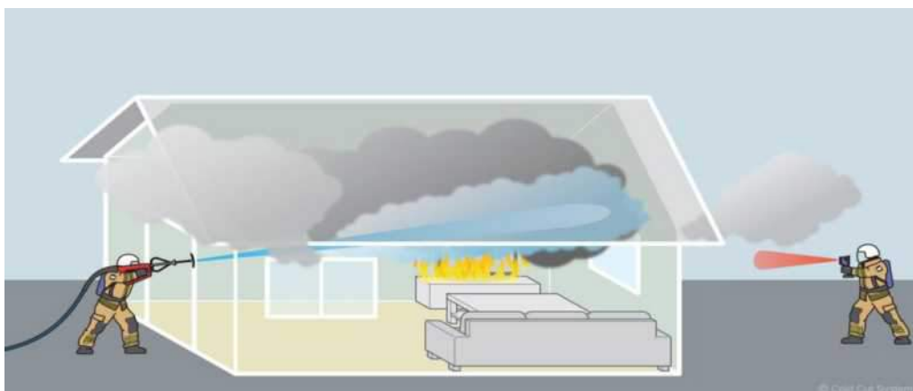
Fig. 6 – Binomul format din camera de termoviziune și Cold Cut Cobra
